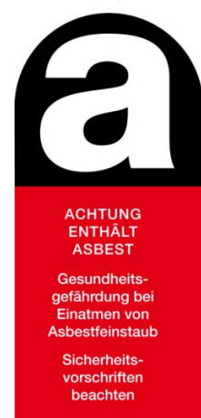
3 Kennzeichen «Achtung Asbest»
